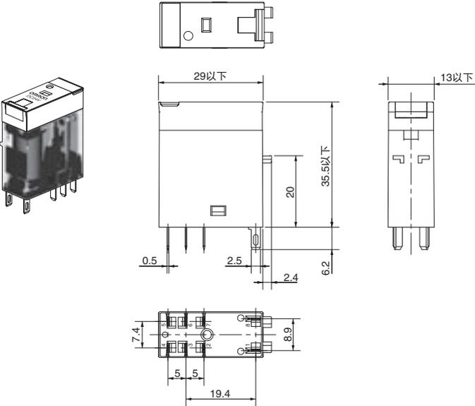
端子配置/内部连接图 (底视图)
