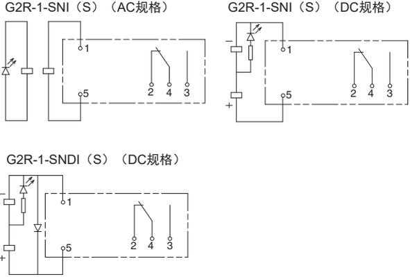
注: 请在确认线圈极性后, 正确接线。
