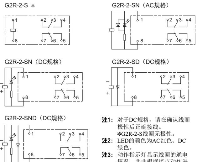
**注1:** 对于DC规格, 请在确认线圈极性后正确接线。
