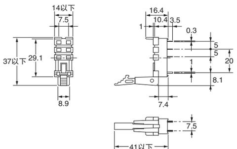
端子配置/内部连接图 (底视图)
